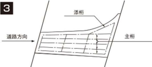
図-1 プレビーム桁の平面配置
