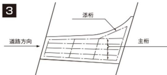
図-1 プレベーム桁の平面配置
