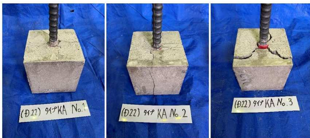
写真 3-3-4 試験後の供試体状況タイプ KA(D22)
